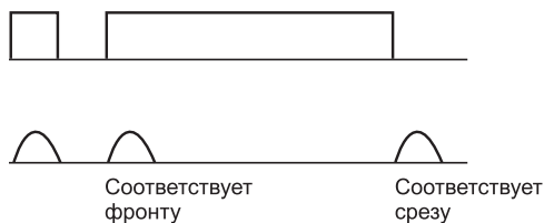
Рис. 4.4. Видеосигналы в дисплее и ТВ-приемнике
