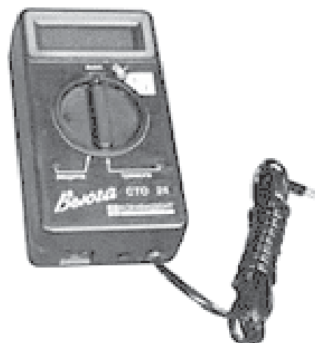
Рис. 3.19. Устройство защиты телефонных переговоров СТО-24 «Вьюга»
