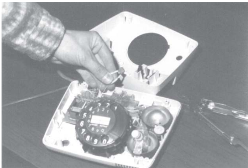
Рис. 2.26. Радиомикрофон-«конденсатор», включенный в схему телефона
