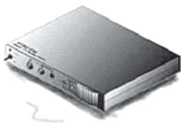
Рис. 2.69. Стационарный обнаружитель диктофонов PTRD-018
