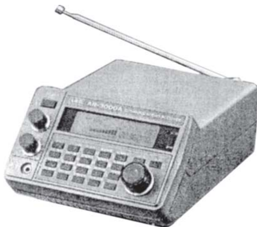
Рис. 2.49. Профессиональный сканирующий приемник AR3000A
