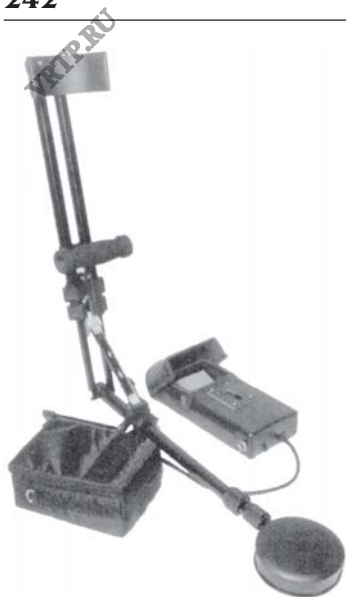
Рис. 5.8. Система для досмотра автотранспорта S-1100 («Дозор»)
